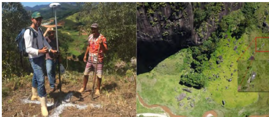
Figura 29 Exemplo de marcação com cal que pode ser aplicada sobre marcos geodésicos em campo (esquerda), tornando-os visíveis nas imagens de drone (direita). Figura cedida pela Dapweb.
