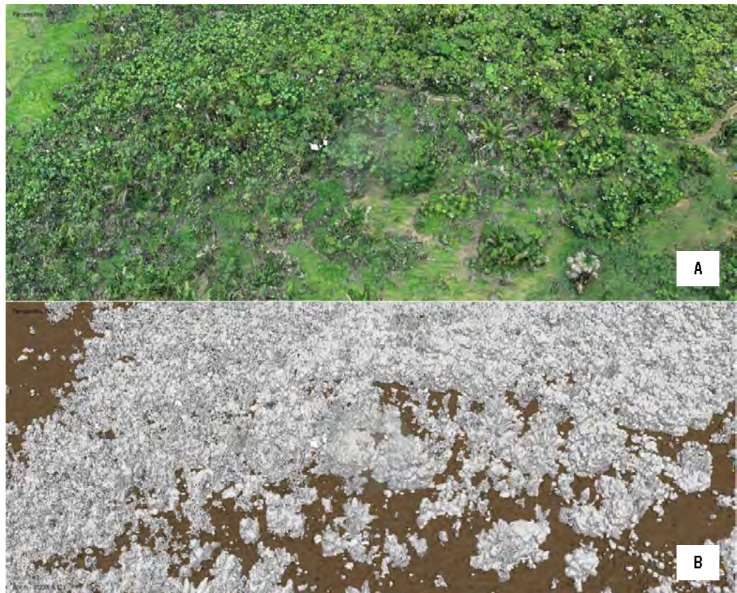
Figura 20 Exemplo de classificação de terreno em nuvem de pontos obtida pelo uso de Drones-rgb. Áreas na cor marrom foram classificadas como terreno.
